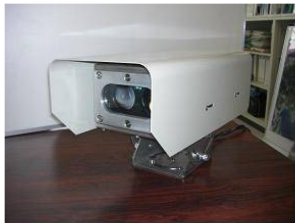
雨や霧にも強い新しいタイプの高精度拡散型 レーザー変位計（企業との共同研究成果）
