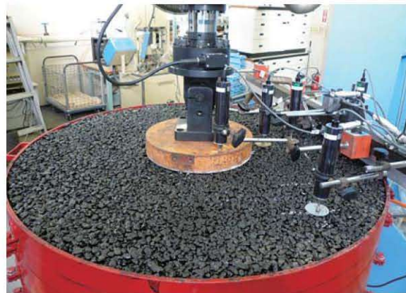
透水性舗装の模型を作成し、浸水させた状態で繰り返し載荷することで舗装としての強度を確認する
